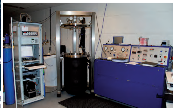
2) Druktesten op duikcomputers. 3) Zo ziet een ANSTI-machiner er uit.
