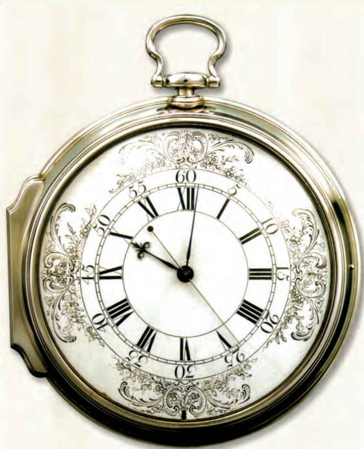
De grote scheepsklok werd door John Harrison verkleind tot zijn handige H4, de chronometer.
