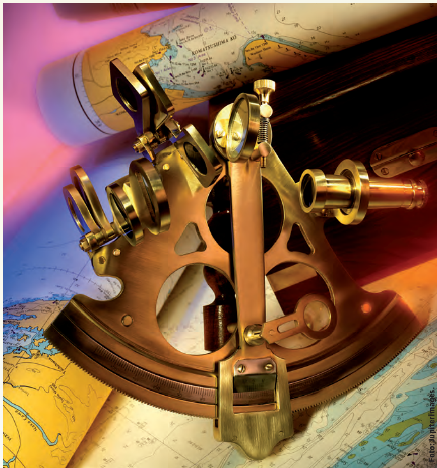
Met een sextant kan de verticale hoek tussen een hemellichaam en de horizon gemeten worden. Als de verticale hoek, de datum en het tijdstip van de dag bekend zijn, kan de plaats waar men zich op zee bevindt berekend worden.
