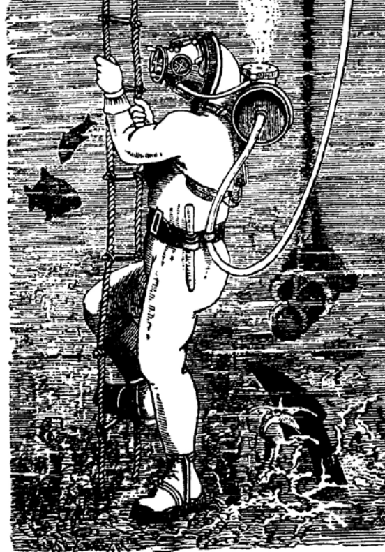
De 'Aerophore' of het Rouquayrol-Denayrouze apparaat (1860).
