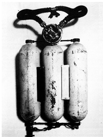
Set van drie flessen voorzien van een CG45, de eerste gecommercialiseerde ademautomaat van La Spirotechnique.
