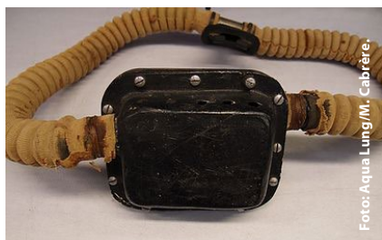
Prototype van de eerste Cousteau-Gagnan ademautomaat, ook wel de CG43 of het 'Scaphandre Aïre Liquide' genoemd.
