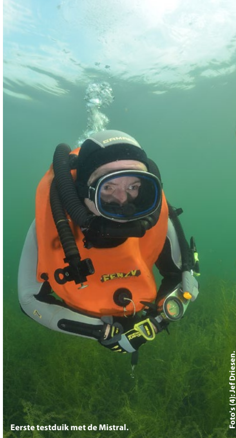
Bij het uitademen komen de luchtbellen niet langs het mondstuk, maar langs de eentrapsonspanner op de rug.
