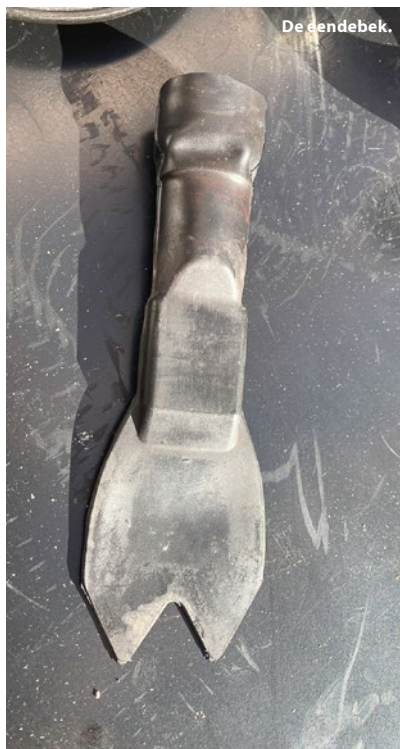
De aangepaste A-klem, zodat ze op de Royal Mistral gemonteerd kan worden.
